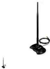
L'antenna desktop omnidirezionale indoor TL-ANT2408C opera nella banda 2.4-2.5 GHz, fornisce un guadagno di 8dBi ed aumenta la copertura e le prestazioni wireless. L'antenna è dotata di un connettore RP-SMA femmina compatibile con la maggior parte degli apparati wireless.
